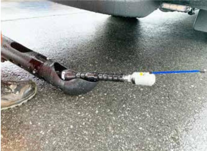
Abbildung 3: Abbiegefähige Schiebekamera der Firma P&B Umwelttechnik aus Saerbeck
