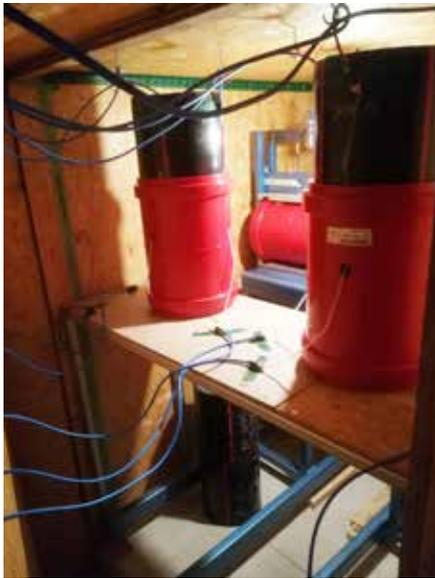
Abbildung 1: Prüfkörper während des Versuchs in der Wärmekammer
