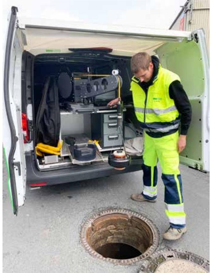
Abbildung 4: Panorama-Schachtkamera der Firma Nehlsen AWG GmbH & Co. KG aus Wilhelmshaven
