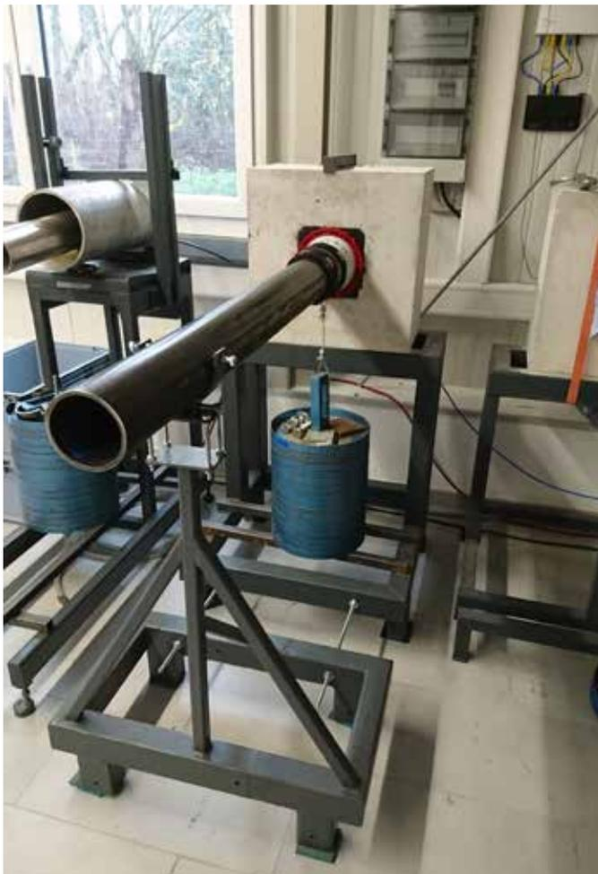
Abbildung 1: Beispiel: Aktualisierter Prüfaufbau für Kabeldurchführungen unter Scherlast gemäß Prüfgrundlage KD101, 09.12.2020
