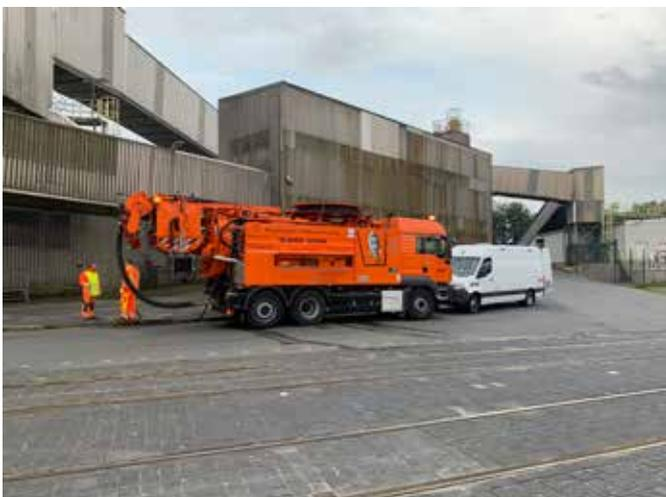
Abbildung 1: Kanalreinigungsfahrzeug der Firma A. Plänscher Entsorgungsbetrieb GmbH & Co.KG
