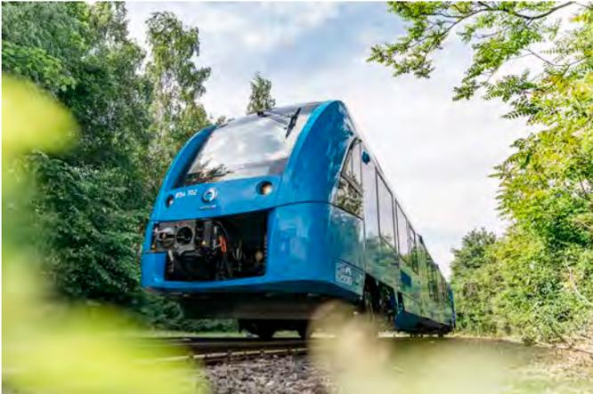
*CoradiaLint ist die Lösung für emissionsfreien Schienenverkehr auf nicht-elektrifizierten Strecken. In Brennstoffzellen wird durch die Reaktion von Wasserstoff und Sauerstoff zu Wasserdampf und Wasser elektrische Energie erzeugt. Der CoradiaLint ist eine Lösung für emissionsfreien Schienenverkehr, die Wasserstoff als alternative Energiequelle verwendet.*
