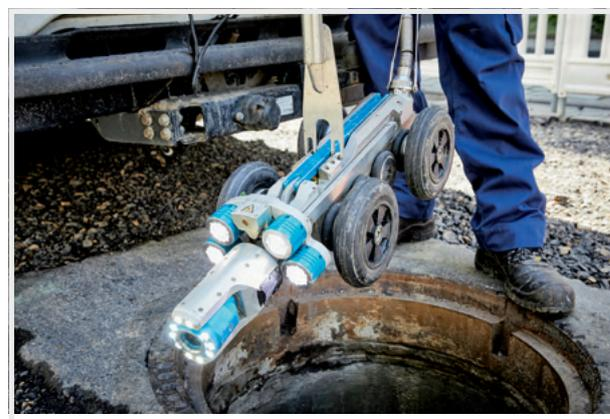
Der Einsatz von KI sorgt für deutlich mehr Effizienz bei der Inspektion von Kanälen.
