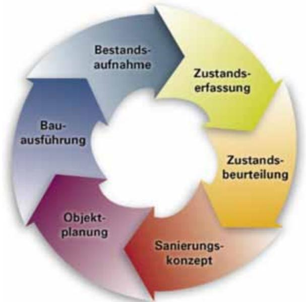
Sanierungsprozess in 6 Schritten
