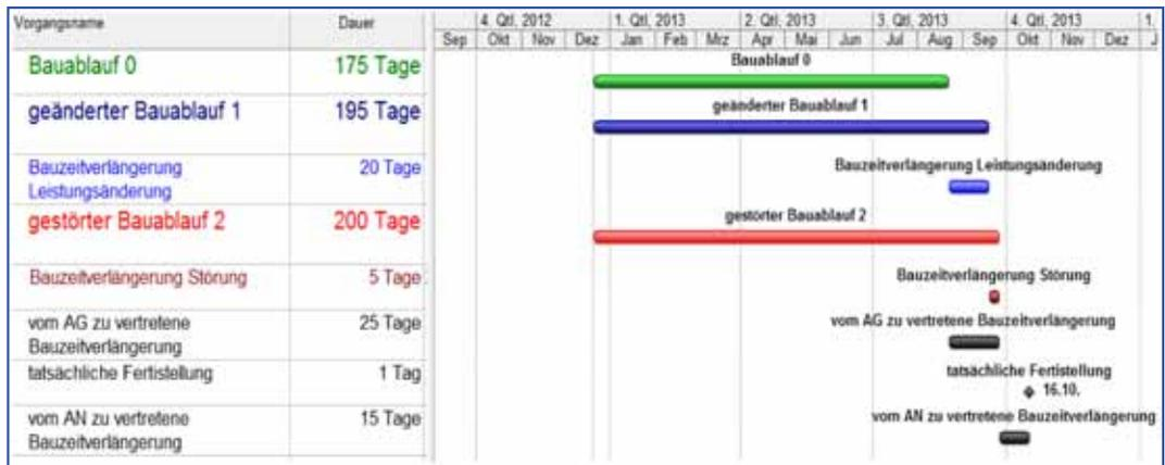
Bauzeitverlängerung durch den Risikobereich des Auftraggebers und Auftragnehmers (In Anlehnung an: <http://www.boetzkes.de/pdf/Boetzkes-Bauablaufanalyse.pdf>, (20.12.2012), S. 14)
