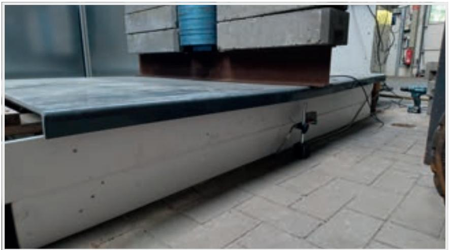
Abbildung 1: Belastungsversuch an PVC-Kunststoffplatten im Prüflabor der iro GmbH Oldenburg (eigene Abbildung)
