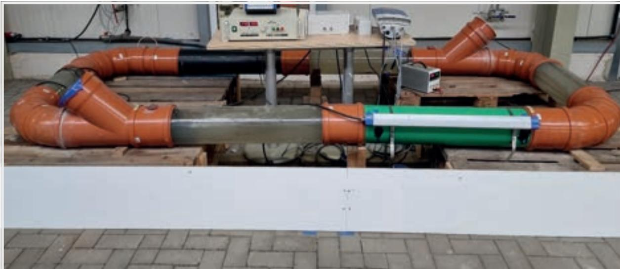
wonnenen Ergebnisse mit den realen Kanalbedingungen zur Durchführung eines Strömungsversuches (Abbildung 3). Auf diese Weise sollte die realitätsnähere Durchströmung der Sedimente durch das Kunststoffrohr und deren Abriebverhalten untersucht werden, da im Kipprinnenversuch das Rohr abwechselnd aus beiden Richtungen belastet wird.
