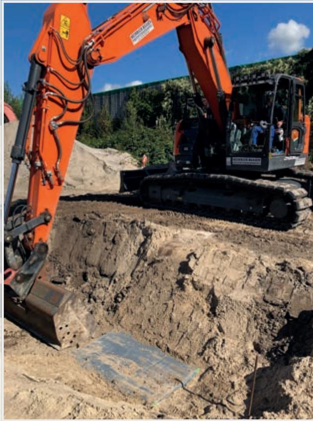
Abbildung 3: Beispiel: Durchführung Druckbelastung auf PVC-Kunststoffplatte durch Bagger
