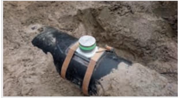
Abbildung 2: Versuchsaufbau: Stahlrohr mit Druckaufnehmer (eigene Abbildung)
