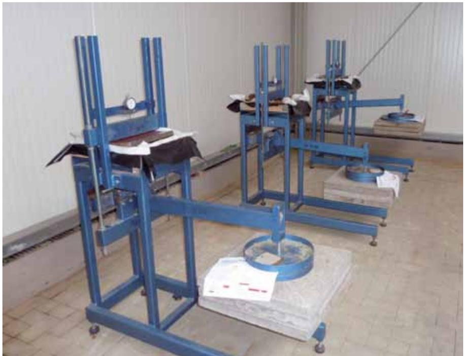
Rohrsegmente und unterschiedliche Bodenproben unter Versuchslast
