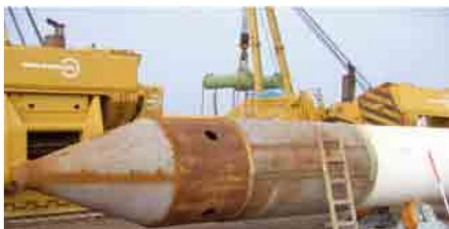
Stahlkopf des Rohrstranges
